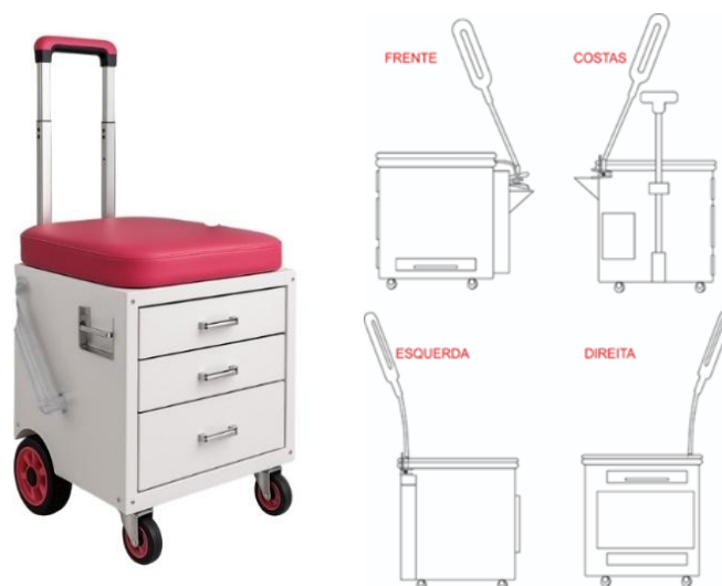
Figura 6 – Esboço técnico de vistas do protótipo (frente, costas, esquerda, direita), facilitando a compreensão de ergonomia e ajustes técnicos
