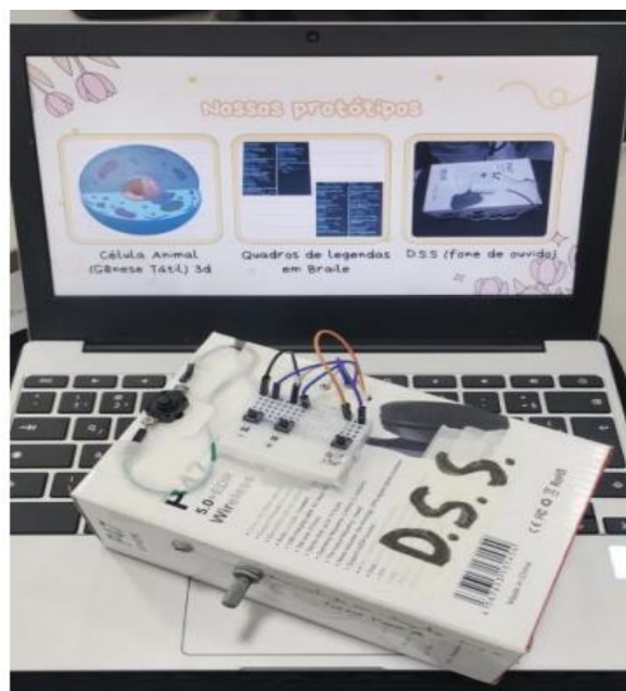
Figura 3 – Caixa de som com materiais de baixo custo
